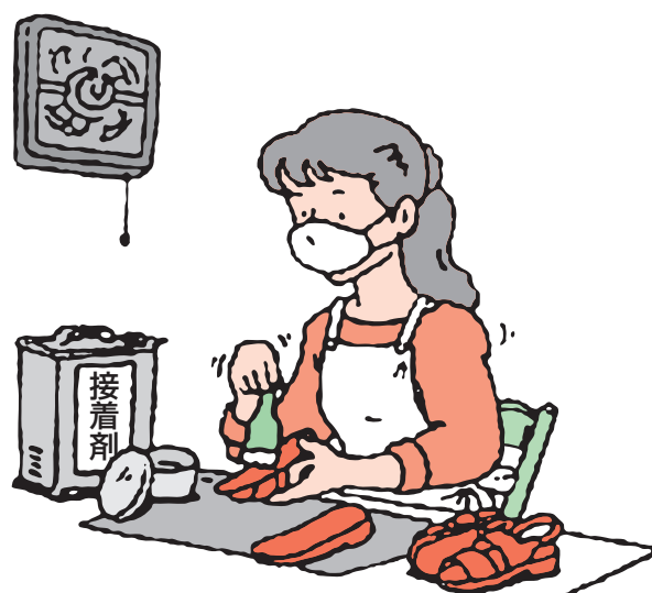
保護具を使用しての作業の例（接着剤の塗布作業）
