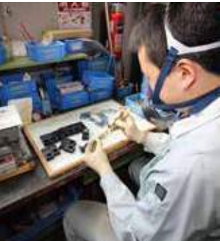
家内労働者には、金属のパーツに接着材を塗布し、ゴムを貼り合わせる作業を委託しています。指の感覚で微妙なズレを修正し、適切な力で圧着しなければならぬ大変手間のかかる作業です。(写真は社員による実演)
