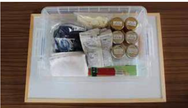
家内労働者には、防毒マスク、フィルター、手袋、有機溶剤、塗布用の筆、拭取用のウェスと作業台をセットで渡しています。有機溶剤の容器には溶剤の名称を記載し、キャップを色分けしてあります。
