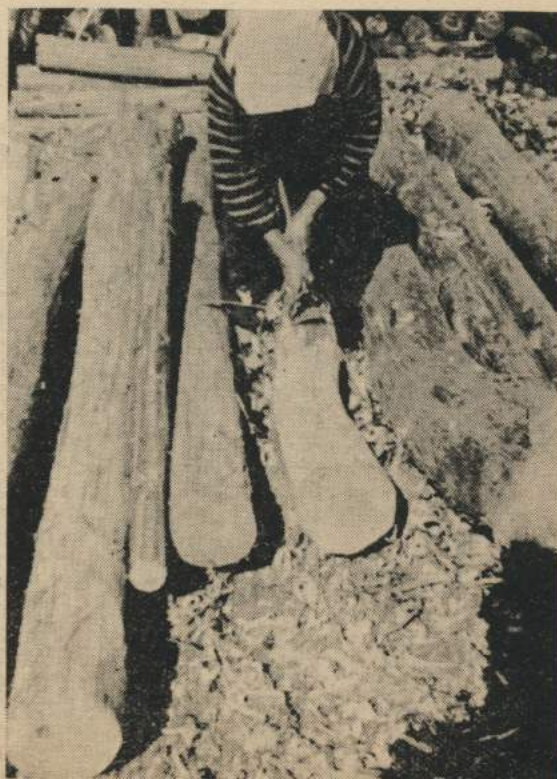
〔皮剥作業〕 鉋を両手で持ち表皮を剥く
