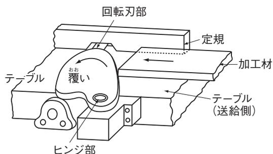
[手押しかな盤の可動式安全装置]
